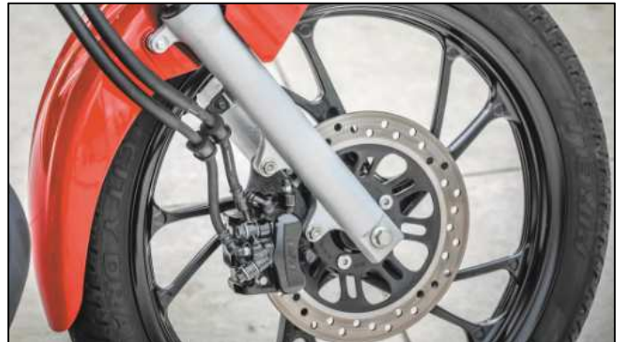
Ferro fundido cinzento: disco de freio de motos
