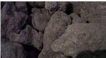
Coque: O carvão mineral quando submetido a altas temperaturas na ausência de oxigênio, se transforma em um resíduo sólido e poroso de alta resistência mecânica e rico em carbono, denominado coque.
