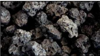
Sínter: Obtido pelo processo de sinterização que consiste na aglomeração a quente dos finos de minério de ferro (juntamente com o carvão moído, calcário e água) para que o mesmo possa ser utilizado no alto-forno.
